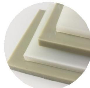
O Polipropileno ( PP ) , é uma resina termoplásticas pertencente ao grupo das poliolefinas que inclui os polietilenos e polibutenos, com ampla faixa de propriedades e grande facilidade de processamento.
