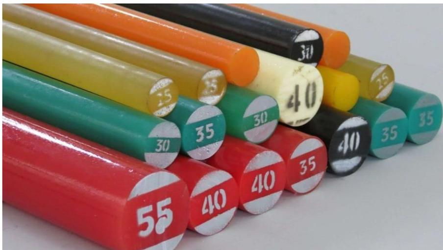
O Poliuretano (PU) é um polímero formado pela reação entre o poliálcool e um isocianato, formando um material elástico e resistente. Produzido pelo processo de fundição.
